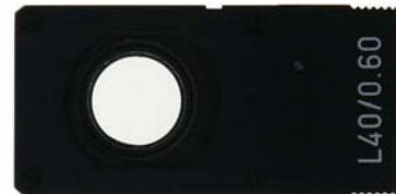
Wollaston Prisma für ein 40x Objektiv / NA 0.6
