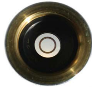
Phasenring in der hinteren Brennebene des Objektiv
