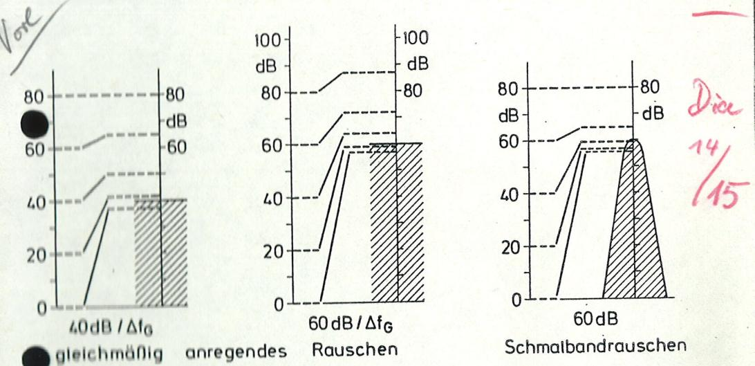
Verschiebung der Phon-Kurven bei Drosselung eines 1kHz-Tones
