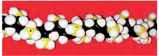
Abb. 3: Isotaktisches Polypropylen. Die Kohlenstoffatome der Methylgruppen sind mit gelben Kugeln dargestellt, um die Übersichtlichkeit zu verbessern und die helikale Struktur zu verdeutlichen: Jede der Methylgruppen ist um 120^\circ gegen die vorangegangene versetzt [12, S. 40], [10, S. 299].
