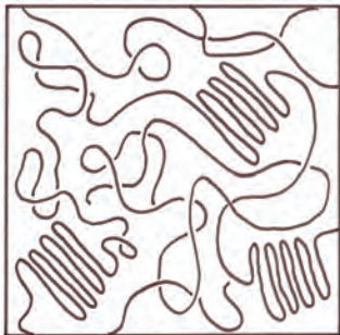
Abb. 2: Teilkristalline und amorphe Bereiche in einem festen Polymer
