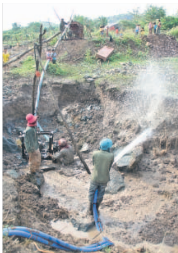
Rubin-Förderung nahe Pailin. Die gelöste Erde wird auf den Waschtisch (hinten) gepumpt.
