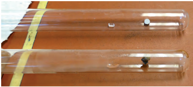
Abb. 3: Schmelzprobe von Kunststoffen: PS (farblos, links) und PVC (grau, rechts) vor dem Erhitzen (oben) und nach dem Erhitzen (unten) in einem Reagenzglas. PS schmilzt zu einer farblosen Flüssigkeit, PVC bläht sich auf und wird schwarz.
