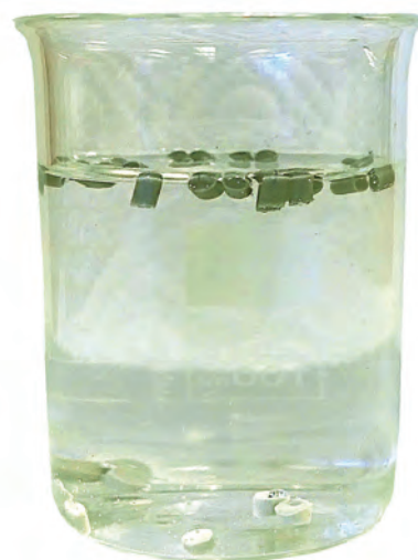
Abb. 2: Abschätzen der Dichte von Kunststoffen: PE-Granalien (grün) und PVC-Granalien (weiß) in Wasser. PE schwimmt, PVC sinkt zu Boden.
